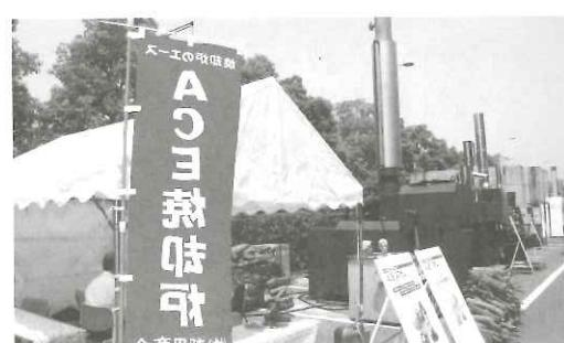
屋外展示で間伐材などのバイオマスを燃料に温水を作る「ACEバイオマスボイラー」を出品している。同社は1994年、自社技術で高温焼却炉を開発し、3年をかけて改善し97年から1300℃の連続燃焼に耐えられる小型焼却炉の販売を始めた。当初より燃焼熱利用を想定しており、近年はバイオマスボイラーとして販売。バイオマスを燃料として使うため、CO<sub>2</sub>削減効果があり、納入実績も増えている。
